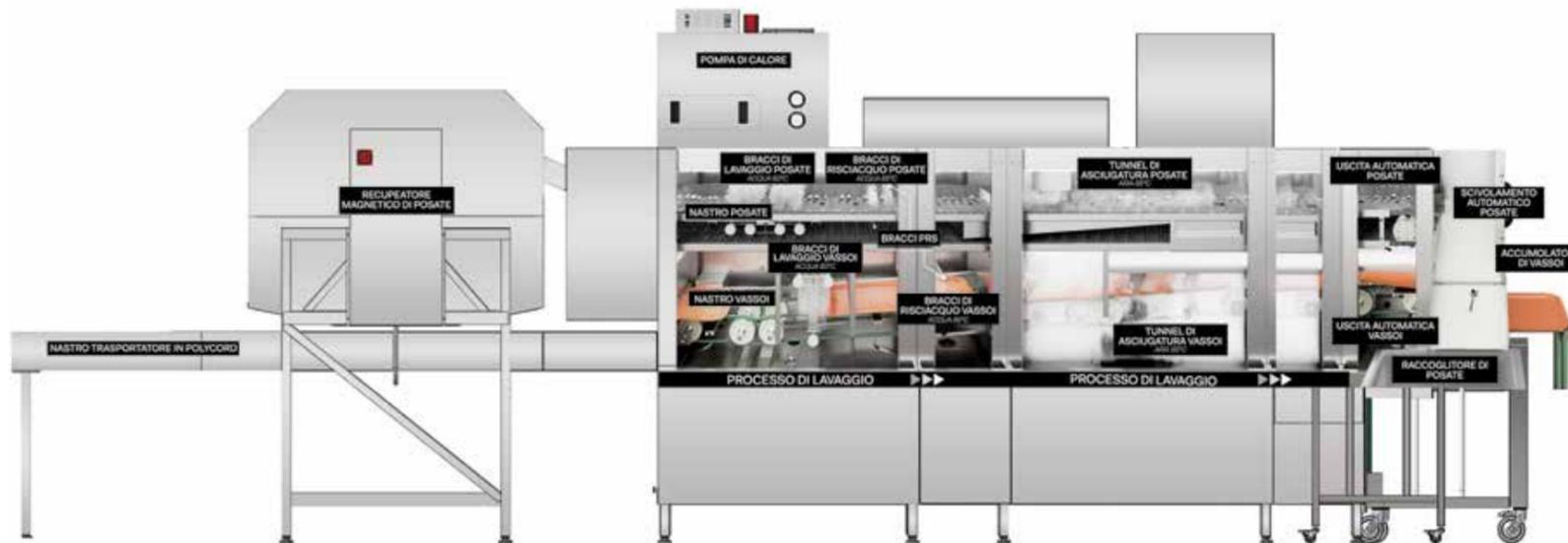
Il modello altamente automatizzato può essere abbinato a un sistema di trasporto che fa avanzare in modo fluido vassoi e posate nell'area di lavaggio, dove un recuperatore magnetico di posate le recupera dai vassoi e le colloca sul nastro superiore. Al termine del processo di lavaggio, vassoi e posate igienizzati vengono raccolti separatamente. Il carrello utilizzato per le posate è alto circa 91 cm, per agevolare il lavoro degli operatori.
